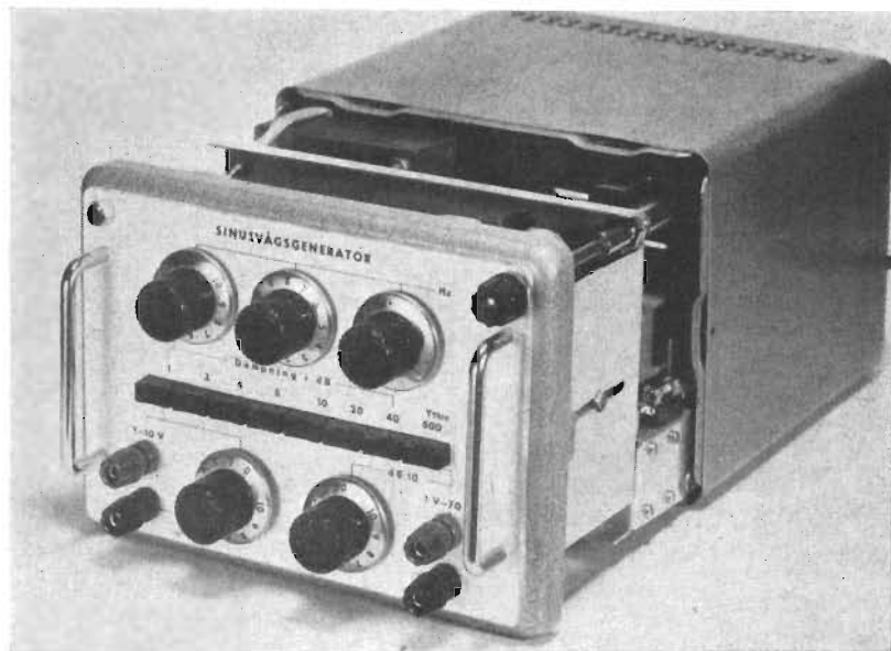
Fig 9 Apparaten till hälften utdragen ur kåpan.
