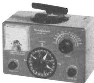
PEJLAPPARAT-RESERADIO, MODELL DF-1
