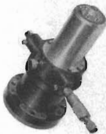
G318 , induktiv transducer för mätning av torsionssvängningar utan att använda släpningar. Givaren fästes direkt på den fria axeländan och följer axelns rotation indikerande vibrationerna. Signalen överföres från ett stationärt koaxialuttag i givarens fria ände. Data: varvtalsområde 0-12000 r/m, frekvensområde 200-100000 vibrationer per minut, amplitudområde ±0,02"-±2°
