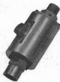
G224R , resistiv temperaturkompenserad transducer för mätning av såväl pulserande som statiska tryck i bränsleledningar för dieselmotorer. Givaren som monteras direkt i bränsleledningen tillverkas m. önskad innerdiameter och utesluter därmed inverkan av skadligt utrymme eller ökning av ledningsmotståndet. Vid beställning anges: tryckområde, innerdiameter, anslutning
