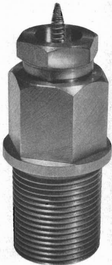
G319 , kapacitiv transducer avsedd för tryckmätningar vid höga temperaturer. Data: tryckområde 0-700, 0-1000, 0-2000, 0-5000, 0-10000 p.s.i., tillåten överbelastning 100 %, temperaturområde till +400°C
