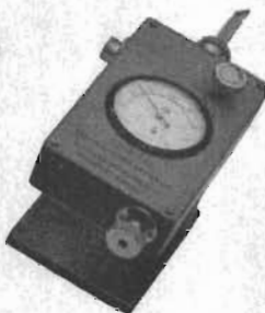
G211 , induktiv transducer för vibrationsmätningar. Mäter utan att beröra mätobjektet. Givaren kan kalibreras, så att amplituden avläses direkt på den mikrometer som ingår i givaren. Data: amplitudområde typ A 0,0001"-0,03", typ B 0,001"-0,1"
