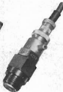
G243 , resistiv temperaturkompenserad luftkyld transducer för distorsionsfria tryckmätningar upp till höga frekvenser. Givaren är försedd med ett friliggande membran, vilket utesluter igensättning och inverkan av skadligt utrymme. Data: tryckområde 0-250, 0-500, 0-1000, 0-2000, 0-5000 p.s.i., frekvensområde 0-20 kHz, linjäritet ±1 %
