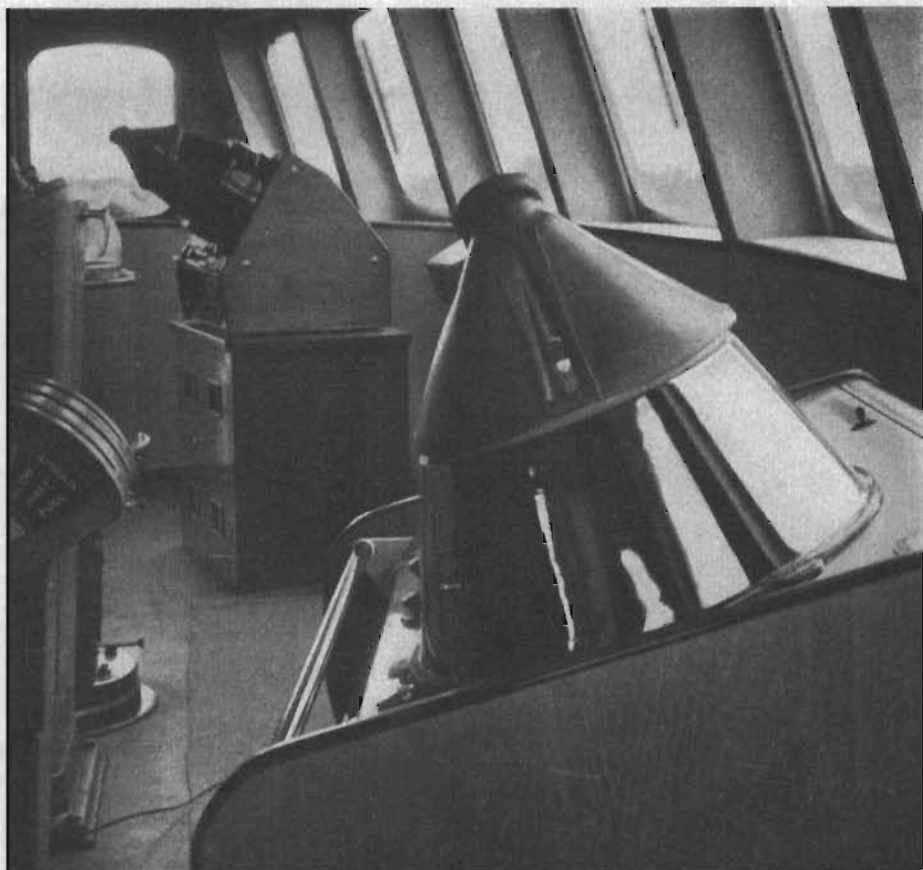
Den engelska järnvägsfärjan »Avalon» har utrustats med en mycket avancerad radaranläggning. På bilden visas de PPI-skärmar som är placerade på kommandobryggan.
