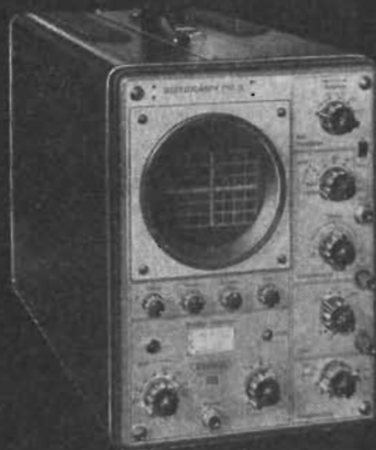
Mätoscilloskop MO 15 Bandbredd: 15 Mc
