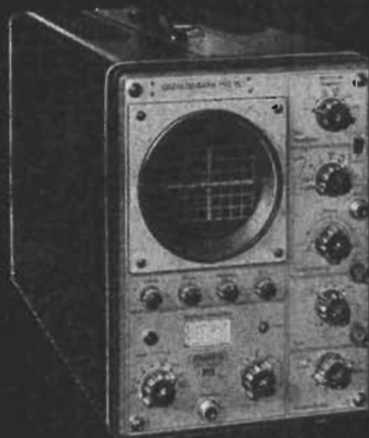
Mätoscilloskop MO 15 Bandbredd: 15 Mc
