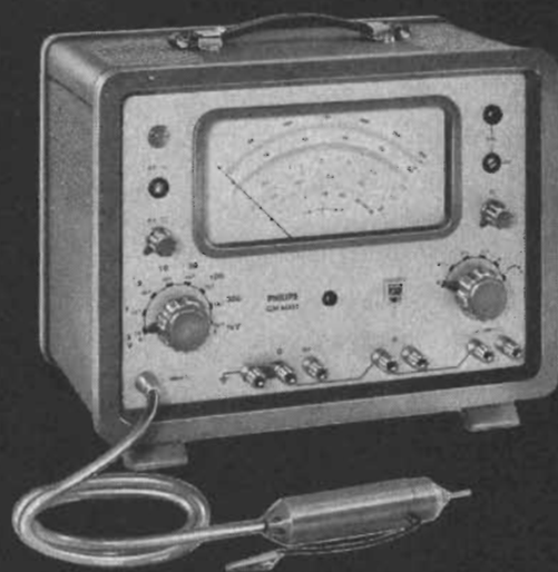
GM 6001 Specialrörvoltmeter för krävande mätningar
