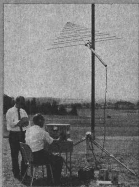
Fältstyrkemätplats HFU med mätmodularen ESU (2 st. HF-enheter står på marken), stativ med log.per.antenn 80–1000 MHz.
