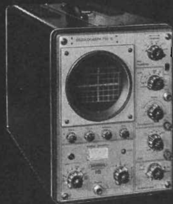
Mätoscilloskop MO 15 Bandbredd: 15 Mc
