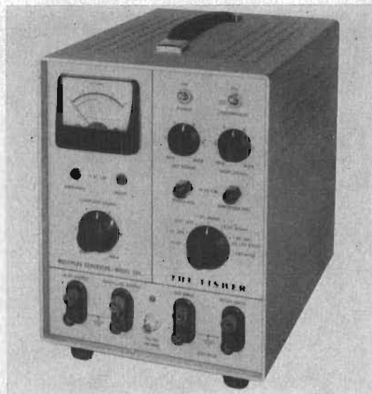
Fig 5 Signalgenerator som ger stereosignal enligt matrisförändret. (Tillverkare: Fisher Radio Corp., USA.)
