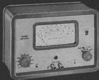
GM 6023 Kompakt bruksinstrument för LF-mätningar
