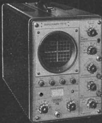
Mätoscilloskop MO 15 Bandbredd: 15 Mc
