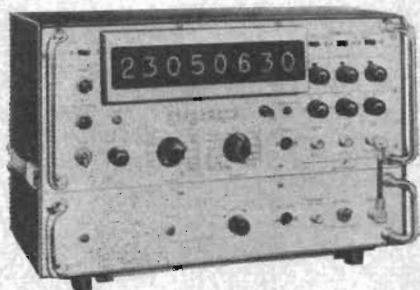
Fig 3 Siffervisande frekvensmeter (8 siffror) för frekvenser på upp till 100 MHz. Tillverkare: Racal Instruments Ltd., England.
