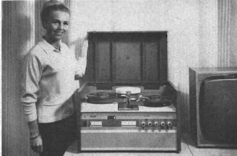
Detta är Philips videobandspelare EL 3400. Den visades för första gången i Stockholm den 10 september i år. Apparaten har yttermåttarna 63×38×42 cm och väger ca 45 kg.
