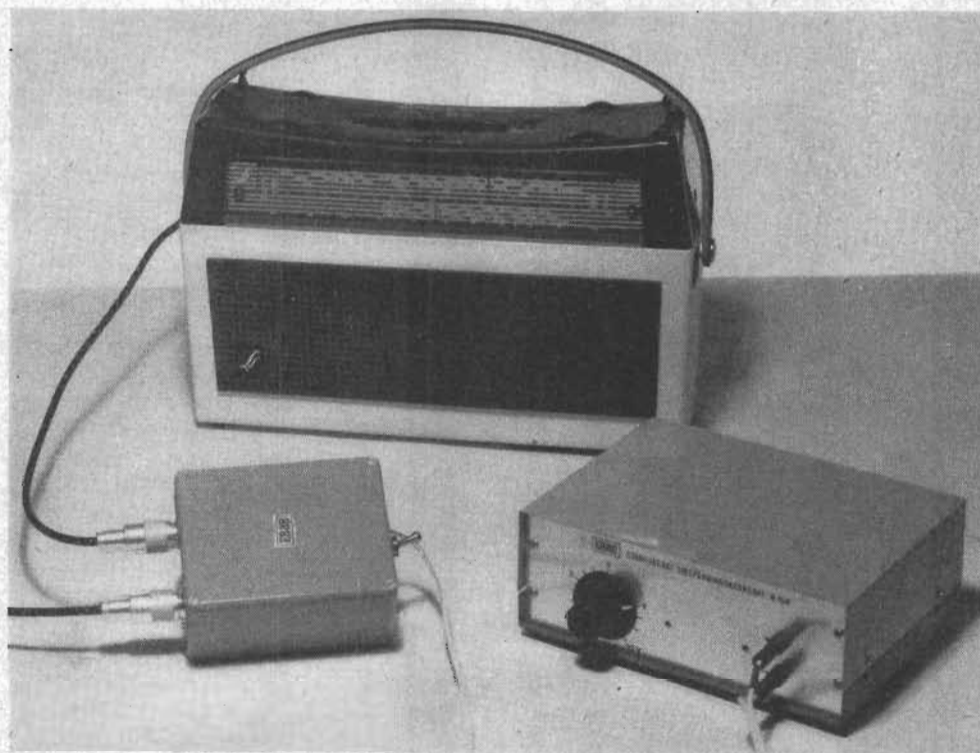
Konvertern (t.v.) ansluten till en ordinär transistormottagare med kortvägsområde. Skärmd kabel måste användas mellan konverter och mottagare så att inte kortvägsfrekvenser går in! Konvertern går bra att köra på 9 V batteri, men här har ett EBaB likspänningsaggregat använts för strömförsejningen.
