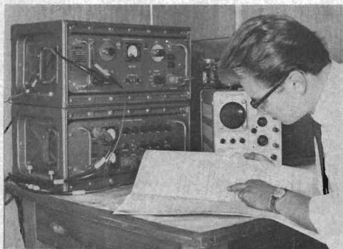
Fig 7 Styrsändarutrustningen för Hi-Fix-systemets huvudsändare.
