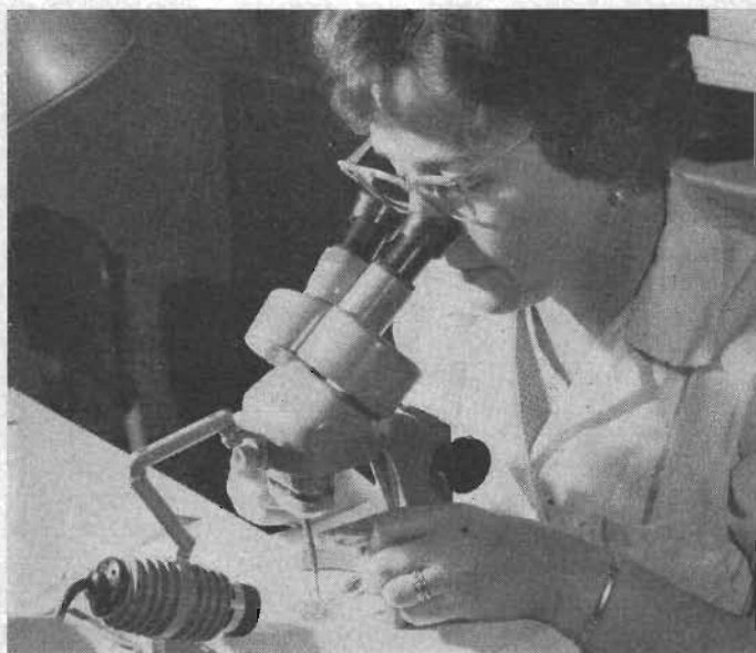
Fig 5 Efter det att själva tunnfilmkretsen är färdig, förses kretsen med transistorer och dioder. Inlödningen av dessa komponenter, som är i mikro-miniatyrutförande, sker under mikroskop. (Foto: Mullard, England.)
