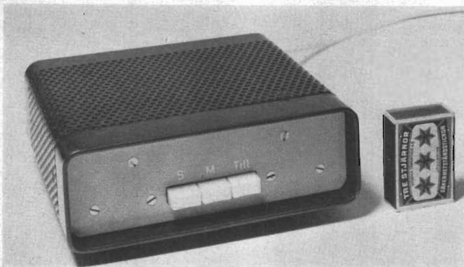
Fig 7 Mottagartillsats för FM-FM-systemet med schema enligt fig. 6.
