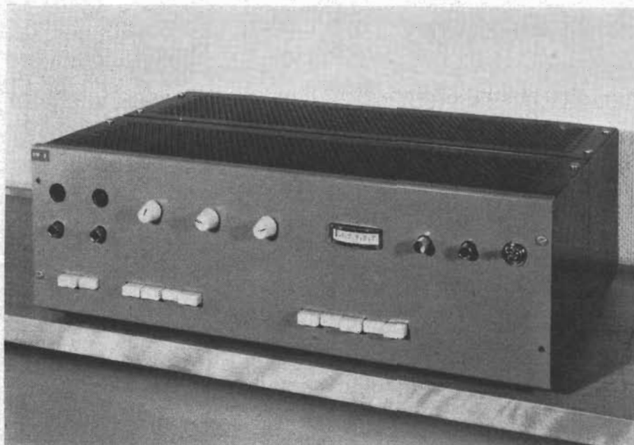
Fig 5 Sändartillsats för 2-kanalöverföring enligt FM-FM-systemet via FM-sändare.
