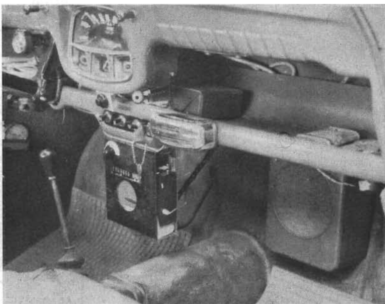
Fig. 3 Kassetten inmonterad i bilen. T. h. en extra 5" högtalare, som anslutes till mottagarens hörtelefonutgång.
