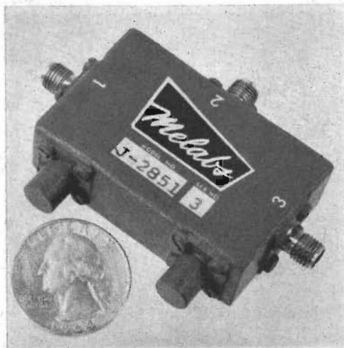
Fig. 1 Melabs cirkulator typ J-2851 för C-bandet, täckande frekvensområdet 5,4—5,9 GHz.
