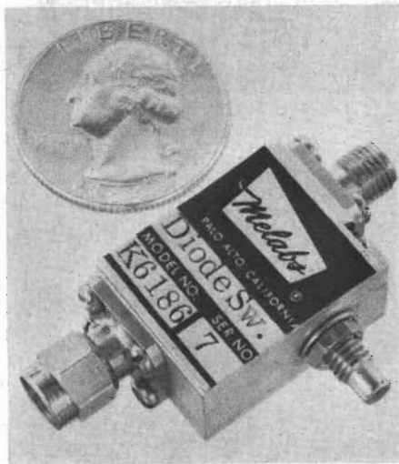
Fig. 2 Bredbandig mikrovågsomkopplare typ K-6186 från Melabs för frekvensområdet 1—8 GHz.
