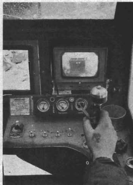
Fig. 1 Byggnadsfirman Ohlsson & Skarne har utrustat en av sina byggnadskrantar med en special-TV-utrustning, omfattande en TV-kamera och en monitor. Som framgår av bilden är TV-kameran monterad på byggnadskranens bom.
