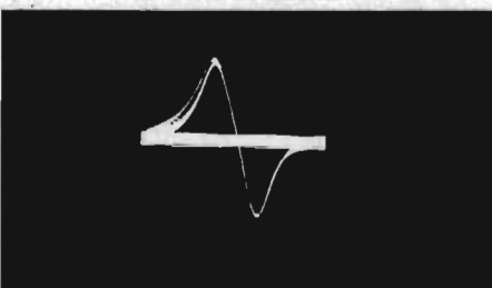
Fig. 8 Korrekt kurvform för en FM-mottagares detektorrets.
