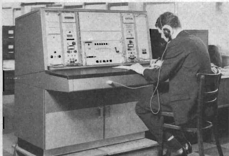
Fig. 2 Från »Speedrace-systemets» fjärrkontrollenhet kan operatören välja mellan 280 000 olika frekvenser inom bandet 2–30 MHz. Frekvensinställningen sker automatiskt för såväl sändare som mottagare.
