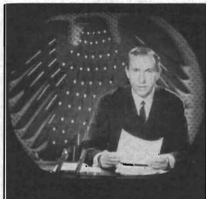
Foto av en svart-vit TV-bild mottagen på en färg-TV-mottagare med runt bildrör, typ 21 FJP 22. Bildkontrasten blir något sämre än vid återgivning i svart-vit TV-mottagare.
