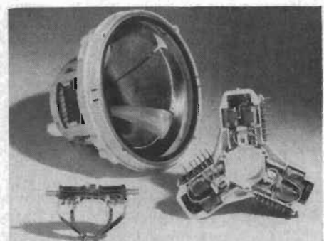
Fig. 3. Nya avböjningsenheter för färgbildröret A63-11X. Överst avböjningsenhet AT1022/02, t. h. korrigeringsenhet (konvergenskorrigering) AT1023/01 och nederst t. v. en korrigeringsmagnet AT1025/01. Tillverkare: Valvo.
