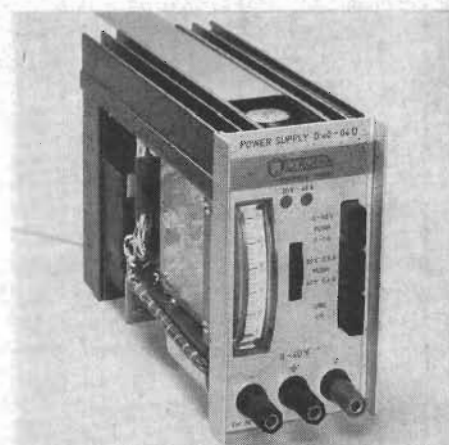
Fig. 5. Serietransistorn syns upptill. Öppningen mot transformatorsidan.
