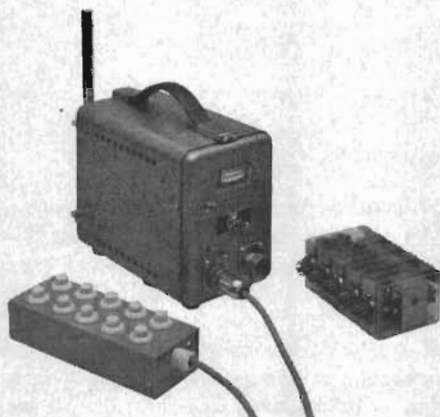
Radiostyrningsanläggningens sändar- och mottagardelar. T. v. manöverenheten, i mitten sändarenheten och t. h. mottagar- och separationsenheterna.
