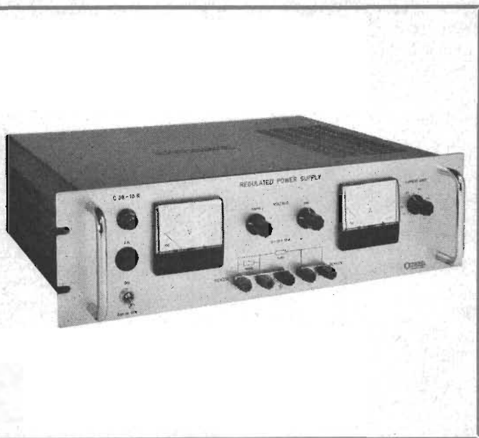
Fig. 12. Schema över seriereglerat aggregat med styrda likriktare som förregulator samt inställbar strömbegränsning. Möjligheter till programmering, fjärravkänning, modulering och konstantström finnes. Aggregatet — av vilket en exteriörbild synes här — lämnar 0–28 V 20 A.
