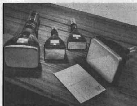
Fig 5. »Röhren mit vier Ecken» står det på baksidan av denna bild från Telefunken , som visar en ny serie rektangulära oscilloskoprör med extremt ringa längd. Från vänster till höger: D8-11, D9-10, D14-11, och M17-11.
