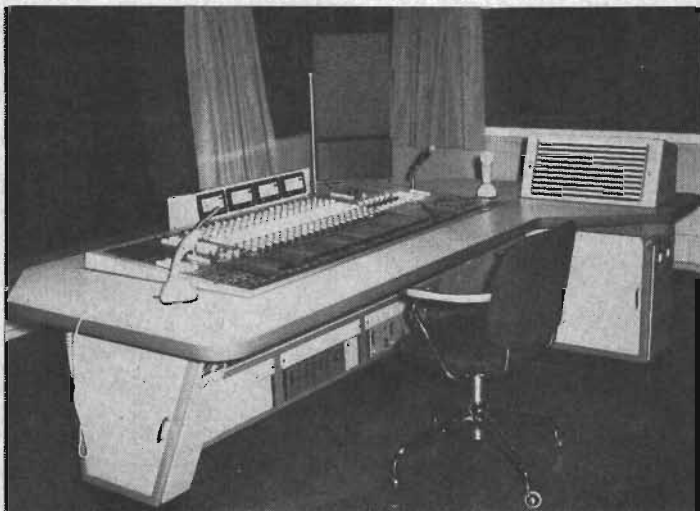
Fig 1. RB-anläggning hos Sveriges Radio i Stockholm. Beteckningen RB är efter regelblocken. Bordets tekniska lösning innebär ett nyskapande inom ljudkontrolltekniken.
