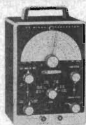
HF-GENERATOR IG-102E. Stort frekvensområde 100 kHz-220 MHz, 6 band. Stor lättläst frekvenskala. Pris: Kr. 225:—
