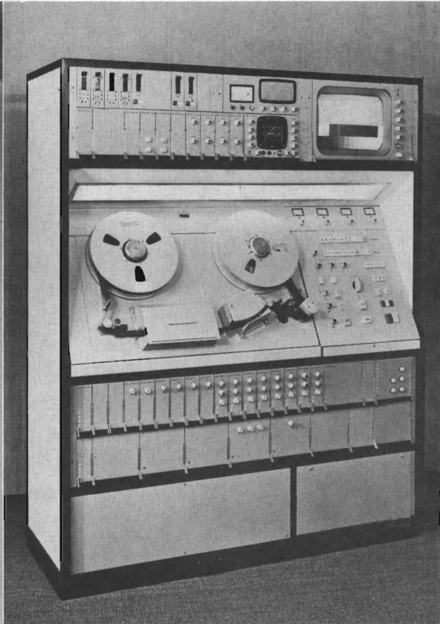
Fig 3. Prototyp för videobandspelare med roterande huvud för färg-TV-studios (Fernseh GmbH).
