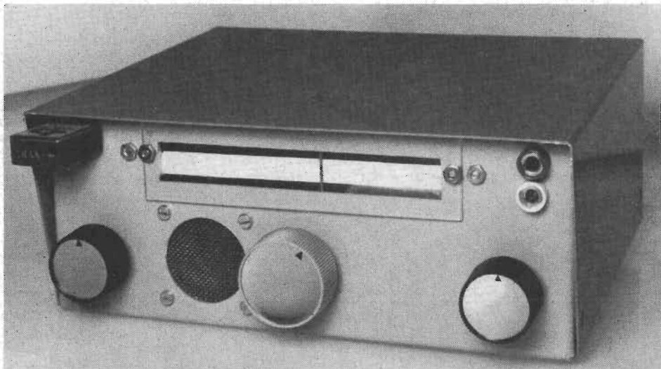
Fig 1. Radiostationen i en apparatlåda med måtten 20×16×8 cm. T v trafikomkopplaren, i mitten frekvensratt och t h känslighetskontroll.
