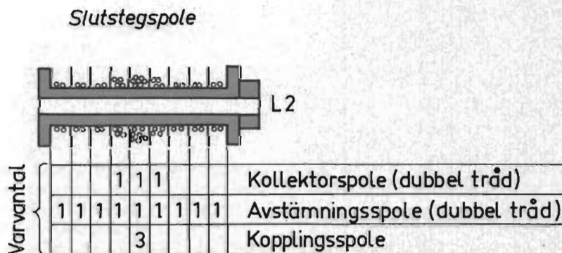
Fig 6. Lindningsanvisning för oscillator- och slutstegsspolar. 0,4 mm lackisolerad koppartråd används.
