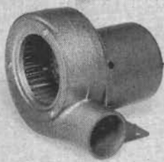
ENGEL turbofläkt totalhöjd 135 mm totaldjup 140 mm 75 m 3 /h vid 10 mm vp
