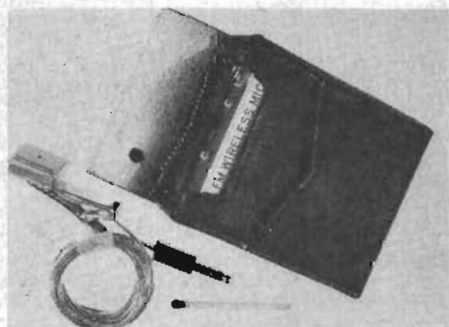
Fig 16. En av sändarna i fig 8 i närbild, här placerad i cigarettetu med fliken tillbakavikt. Sändaren har inbyggd mikrofon placerad mittför hålet i fliken, men en yttre mikrofon i form av en slipshållare medföljer också. Den inre mikrofonen urkopplas automatiskt när den yttre ansluts. Sändaren saluförs i Sverige. Räckvidd ca 100 m.
