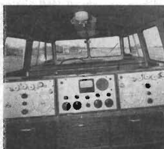
Fig 3. Lyrec inspelningenheter TR 2 och förstärkarenhet AR 2 installerade i en VW-buss som även rymmer omformare för 220 V, 50 Hz. (Foto: Uppsala-Bild).
