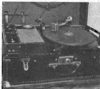
Fig 2. Graververk Telefunken Ela T 39, anskaffat av arkivet år 1935, senare modifierat med en VU-meterförsedd AGA-förstärkare (t v). Apparaten var en av de första i sitt slag i Sverige och efterträdde Edison-fonografen med rent akustisk upptagning. Den mikrofon som tillhörde T 39 var typ Reiz med kol-korn (s k sockerbit).
