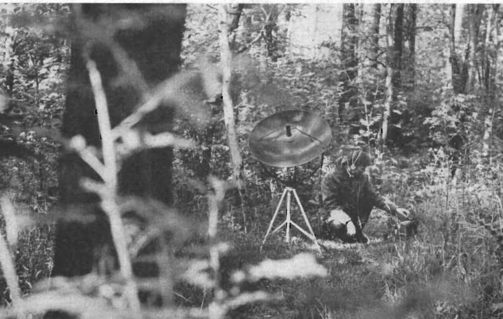
Fig 8. Reflektormikrofonen anbragt för upptagning av fågelläten.
