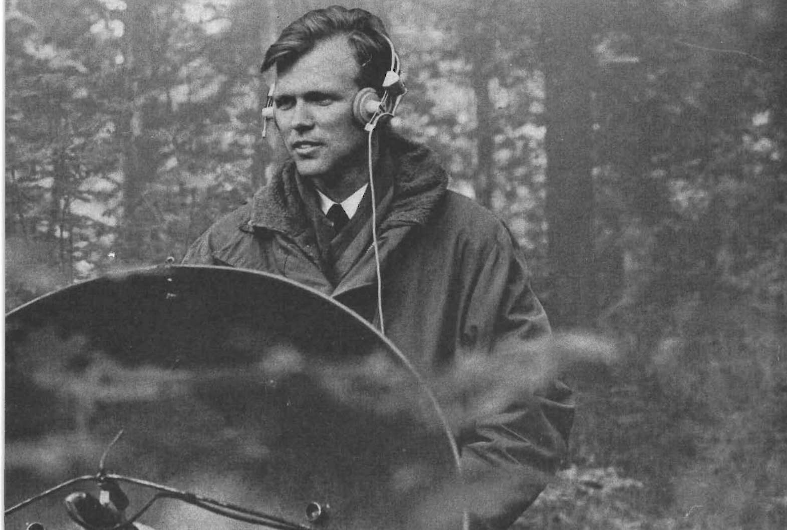
parabolisk reflektor. För en reflektor med diametern 80 cm uppgår förstärkningen till ca 30 dB.
