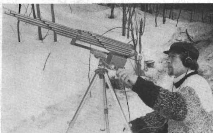
Fig 16. Riktmikrofonen är mycket användbar för avlyssning av fåglar. Märk att öppningsvinkeln vid avlyssning på långa avstånd är mycket snäv, varför stativ måste användas. Detta bör ha ett kraftigt panoramahuvud för att förenkla inställningen.
