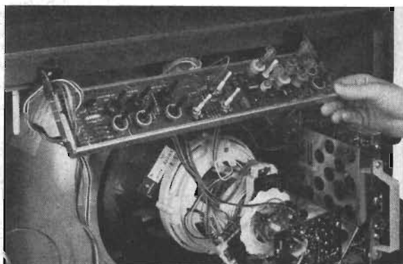
Fig 5. Krets-kortet för konvergensinställning är upphängt baktill i lådans överkant och kan vridas 180°, så det blir åtkomligt medan man betraktar bildskärmen.
