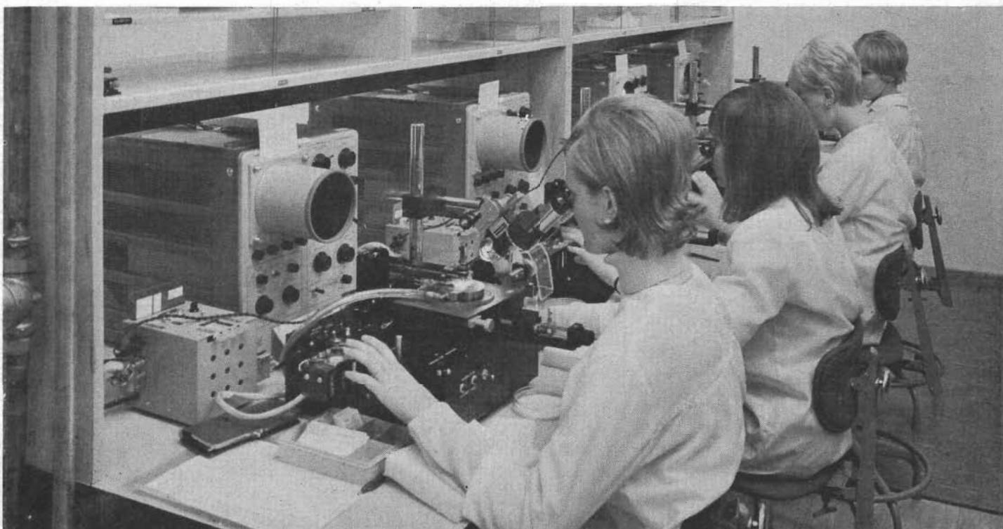
Fig 1. Varje planarskiva, som kan innehålla upp till 9 000 halvledarbrickor, kontrollmäts med kurvskrivare. Defekta brickor märks med magnetiskt bläck, så att de efter delning av skivan lätt kan sorteras bort med magnet.
