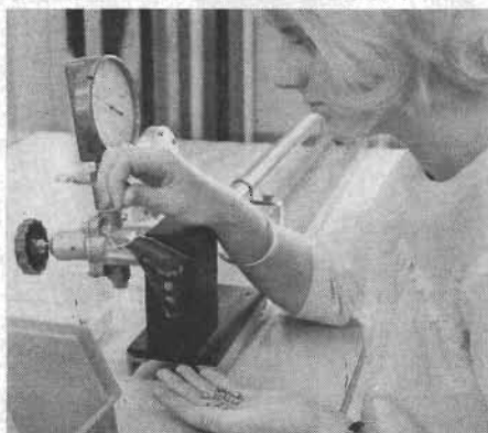
Fig 4. Färdigkapslade transistorer »avfyras» med tryckluft genom ett rör, så att de utsätts för påkänningen 25 000 G. Dåliga förbindningar bricka-kapsel bryts.
