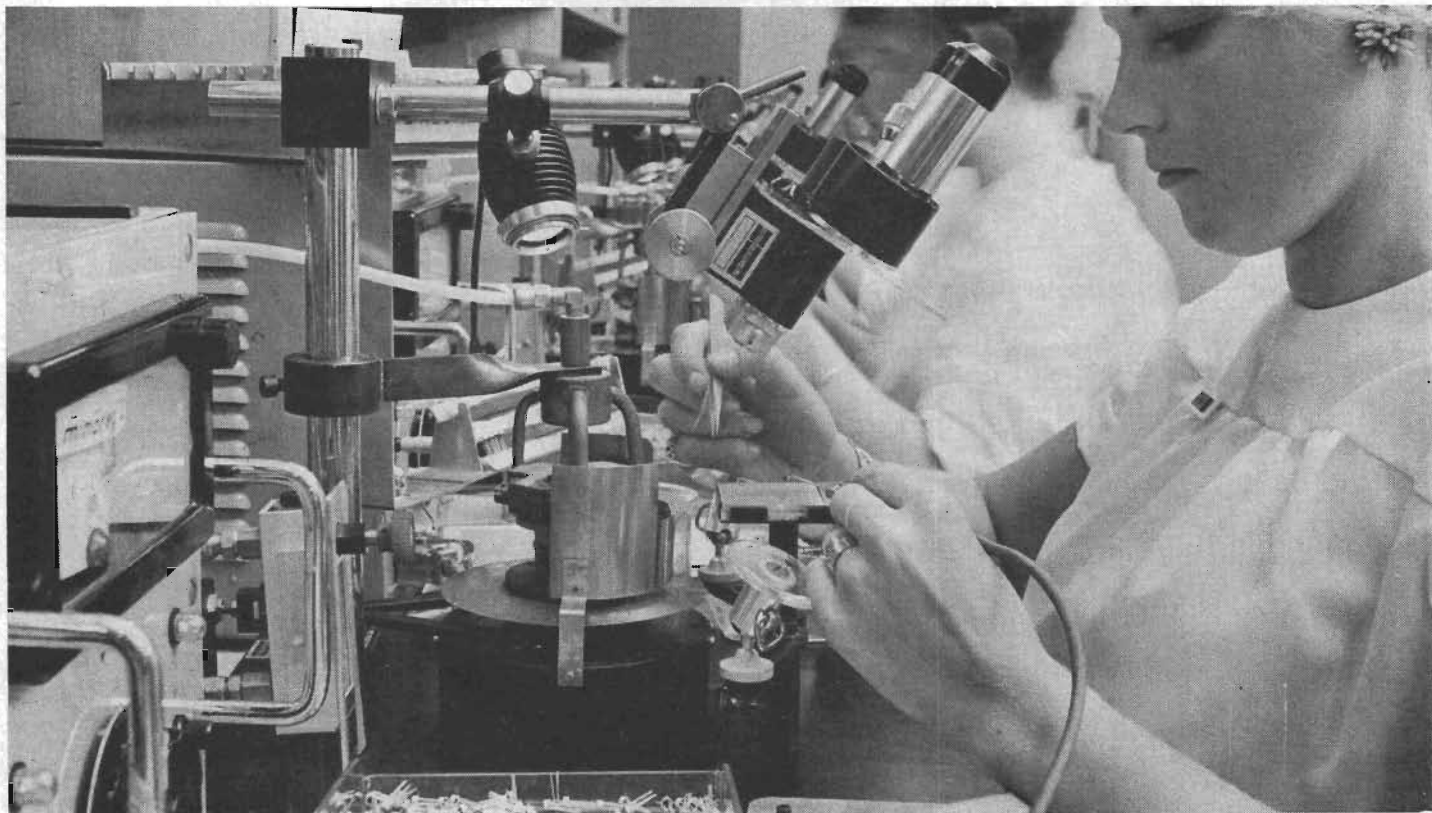
Fig 3. Efter kontroll av parametrar löds brickorna med guldlod på TO-kapslarnas botten. — T v lödfixturen; verktyget med slang t h är en vakuumpincett.
