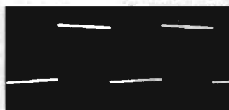
Fig 6. Kantvågssvar vid 10 kHz.
