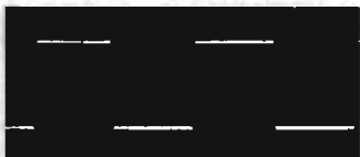
Fig 5. Kantvågssvar vid frekvensen 100 Hz.
