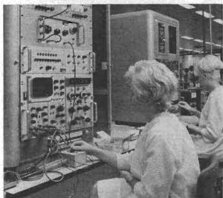
Fig 5. Uppmätning av switchtider ingår som ett viktigt moment i den elektriska slutprovningen. Instrumentet är programmerat med en övre och en undre tillåten gräns.
