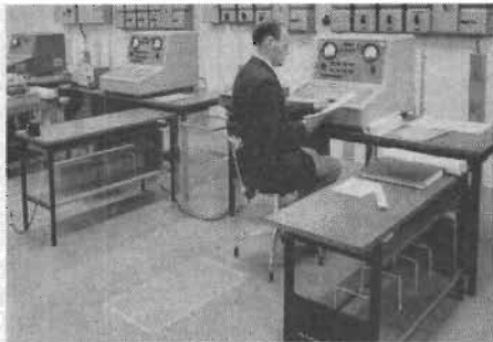
Fig 4 b. Foto visande artikelförfattaren vid manöverbord till en av de digitalmaskiner av typ Saab NSK3B som ingår i det av Saab för beräkningar och simuleringar använda hybridsystemet. Maskinerna har en sammanlagd minneskapacitet på 20 000 ord med 13 och 26 bitars längd. Additionstid är 6 \mu s, multiplikationstid 83 \mu s.
