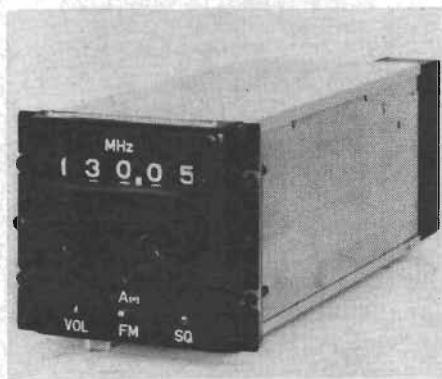
Fig 1. Sändar-mottagarenheten AMR-201 vilken används som grundenhet vid sammansättning av en AMR-200-station (bilden ovan).
