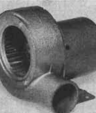
ENGEL turbofläkt totalhöjd 135 mm totaldjup 140 mm 75 m 3 /h vid 10 mm vp
