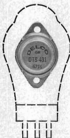
DTS 431 I_c = 5 A V_{CEX} = 400 V F_t = 4 MHz
