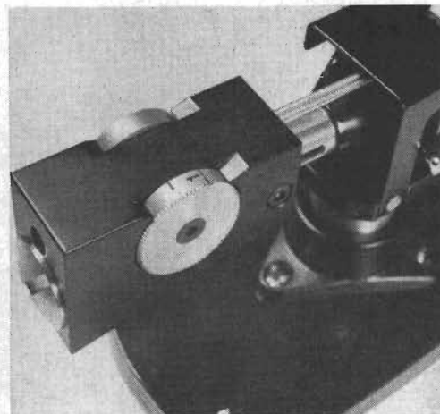
Fig 3. Inställning av nåltryckskraften sker med den graderade ratten i motvikten. Man vrider på ena sidan och kan avläsa inställt värde på motsatt sida. — På fotot syns också den utskruvbara plugg med vilken motviktens massa kan reduceras.
