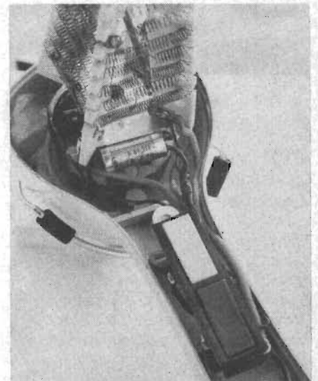
Fig 3 c. Störningsskyddet inkopplat i hårtorken.
