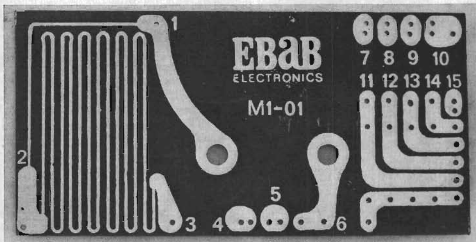
Fig 12. Kretskortet för testinstrumentet har shuntar inbyggda i ledningsmönstret och kan monteras direkt på det vridspoleinstrument 0-1 mA, 60 ohm, som ingår i testinstrumentet.
