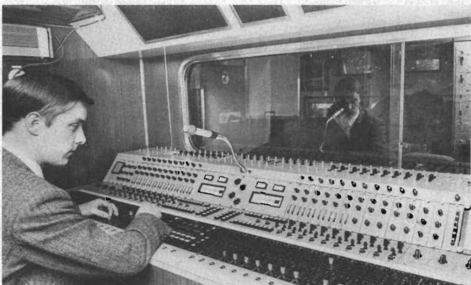
Fig 3. Ljudkontrollbordet i »färgbussen», genom fönstret ser man en del av färgkontrollrummet.
