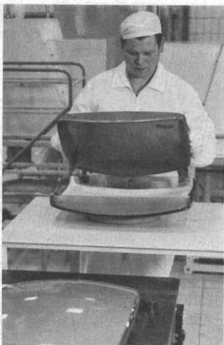
Fig 1. Ett moment vid tillverkning av färgbildrör: Insättning av hålmask för belysning. Då man framställer rastret på skärmglasets insida, tjänstgör hålmasken som positiv. Varje hål i masken är tilldelat en grupp med tre färgpunkter som framställs efter varandra genom belysning med punktformiga ljuskällor. Efter detta belysningsförlopp hör hålmask och bildskärm direkt ihop med varandra — de har »ingått äktenskap» skulle man kunna säga.
