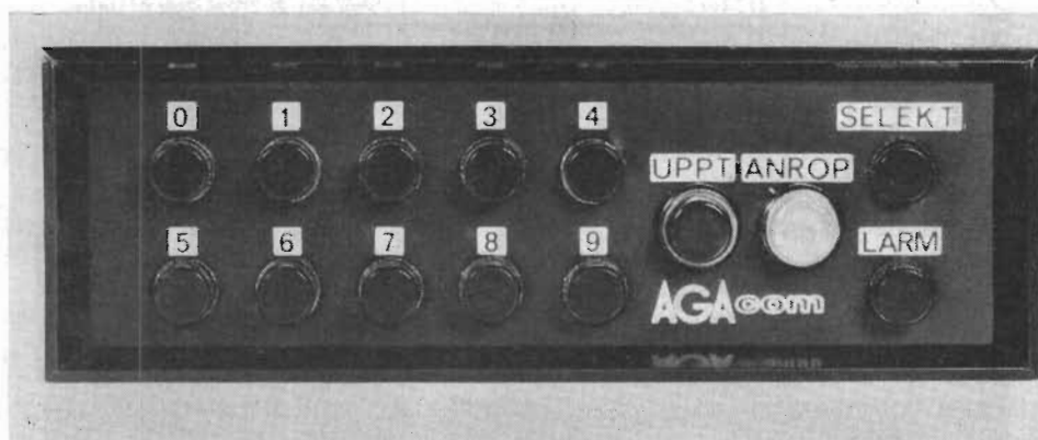
Fig 19. Panelen till en kombinerad tongivare/tonmottagare, avsedd att användas i system med två- och treställiga koder av typ 1. (AGA)
