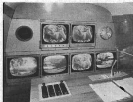
Fig 6—7. TV-inspelning med mobil enhet (OB-buss). Sex kameror kan anslutas över regi-mixern i kontrollrummet.
