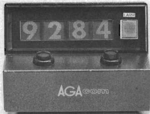
Fig 21. Presentationsenheten för ett ID-system med fyrställig tonkod. (AGA)
