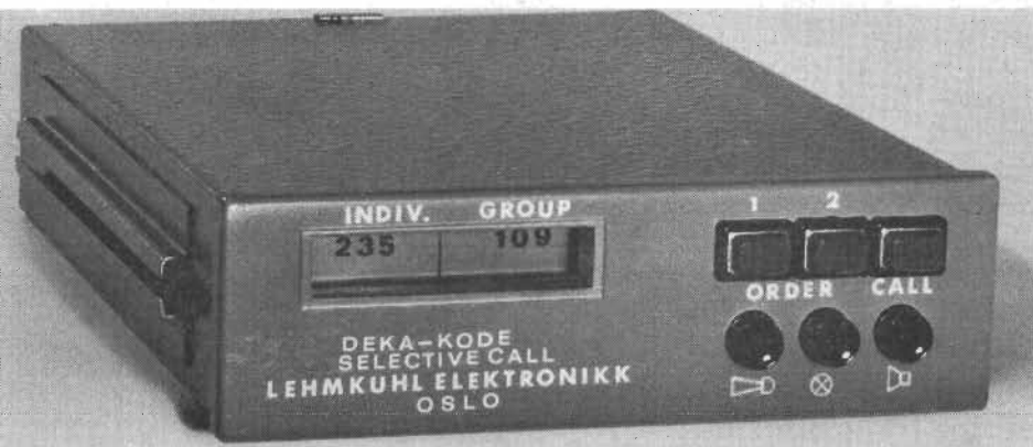
Fig 20. En tonmottagare av generell typ, här utförd för två olika koder svarande mot individ- och gruppanrop. (Lemkuhl)
