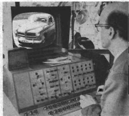
Fig 1. Industriföretag kan i hög grad rationalisera sin bevakning med TV-system för fjärrkontroll av sekundärgrindar och portar. Med fjärrstyrda kameror, försedda med zoom-objektiv, kan man övervaka grindpartier och avläsa bilnummer. (Securitas.)
