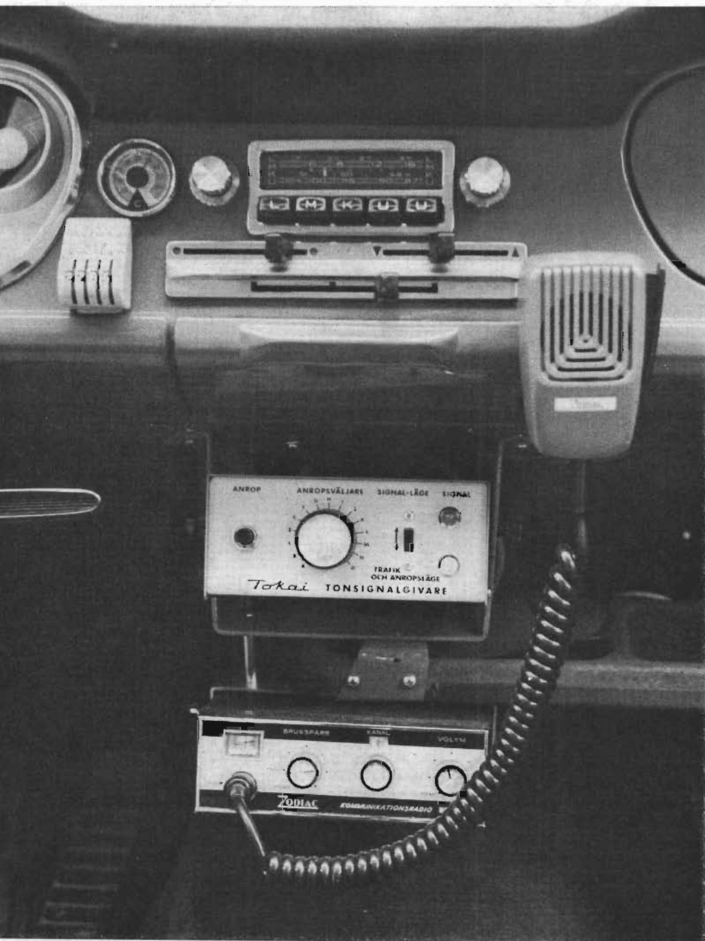
Fig 2. Zodiak-stationen som mobilutrustning, monterad i en stationsvagn tillsammans med Tokais tonselektivutrustning.
