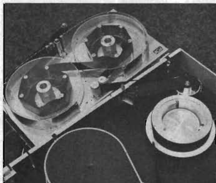
Fig 13. AGA:s patentsökta videokassett med ändlöst entimmes-band.
