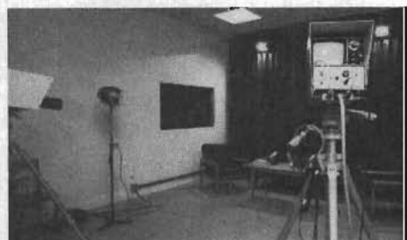
Fig 3. ITV-studie för talartäring och TV-framträdande. — Bilden togs i anläggnings-skedet och sedan dess har ytterligare åtgärder vidtagits för att reducera efterklangstiden. Kamerorna är anslutna till en videomixer, men de kan även användas »i fält» och är då självförsörjande med synk-signal. (Bildmaterialet fig 3-9 från Studioproduktion AB, Lidingö.)
