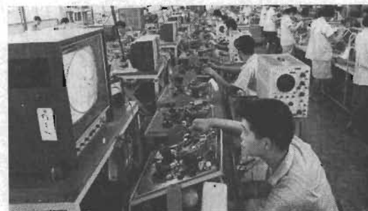
Provning av videobandspelare före slutmontering. Shiba Electric, Tokyo.
