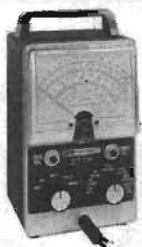
Rörvoltmeter IM-11E 1,5 V-1 500 V AC och DC. Resistans 0,1 ohm-1 000 Mohm.
