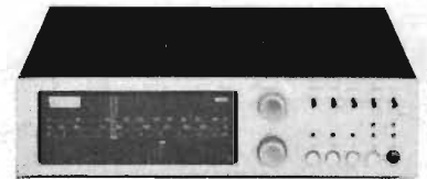
Fig R. Brauns Ce 1000 har utom FM-bandet fyra AM-områden. Automatisk frekvensreglering och variabel bandbredd. Relästyrda omkopplare med optiska indikatorer. HF bestyckad med nivistorer; i övrigt helt transistoriserad. En konstruktion som stått sig väl trots att den inte direkt är ny.
