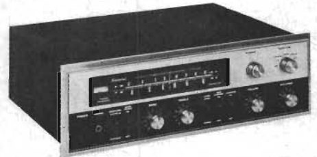
Fig V. Japanska märken som Pioneer, Sansui och Nikko m fl har under ett par års tid sålts bra i Europa, framför allt i England och Tyskland. Nu hörjar också Sverige bli en marknad för dessa apparater. Bilden visar en enhet ur Sansui-programmet, som fått svensk generalagent. Det är en 60 watt AM/FM-receiver. Känsligheten anges till 1,8 \mu V, selektivitet bättre än 50 dB vid 98 MHz.
