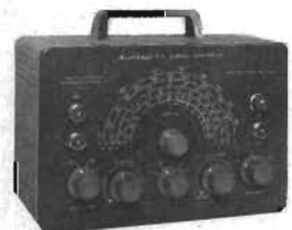
Signalgenerator IG-102E 100 kHz-220 MHz \pm 2 %.
