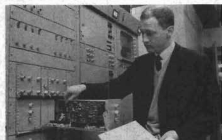
Fig 5. Interiör från testbildrummet. Kontroll av ett stativ med generator för mät-signaler på TV-nätet.
