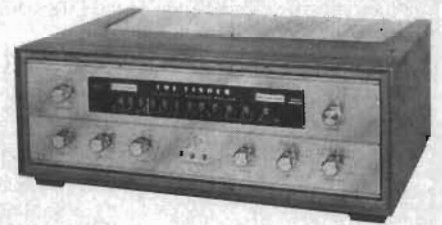
Fig K. Föregångaren till TMF-1000 från Fisher hette FM-1000, »Wide Band FM Multiplex Broadcasting Monitor» och innehöll 18 rör och 14 dioder samt den berömda Golden Cascade Front End, sex mellanfrekvenssteg och fem begränsarsteg...
