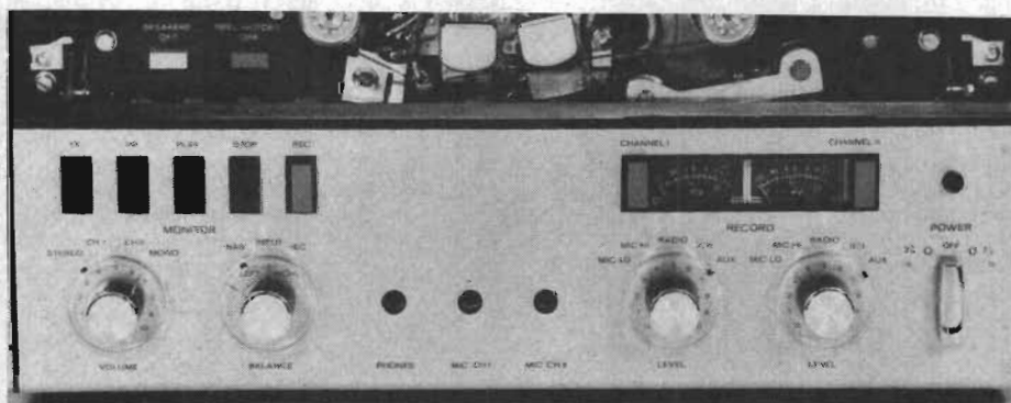
Fig 6a. Närbild av manöverpanelen. De olika manöverfunktionerna framgår av bilden. Mikrofon och hörtelefon kan anslutas på bandspelarens ovansida.
