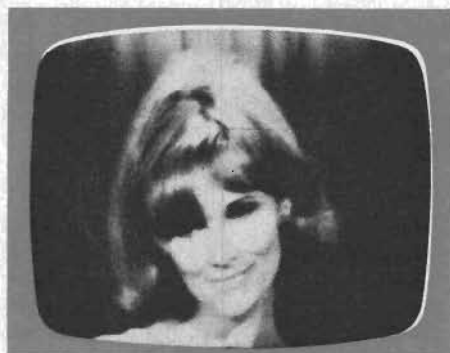
Fig 4. Ett vanligt järnoxidband gav en mycket snöig bild, särskilt i belysta partier (överst) när videobandspelaren kördes med halva sin hastighet, medan ett Crolynband knappast gav någon försämring alls. De mycket utlysta och ljusa bildpartierna i detta FM-system företräds på det »vanliga» bandet av de kortast registrerade våglängderna. Ljus- och kontrastförlusterna, den totala »drop-out» här beror på undermålig HF-återgivning. »Snön» överallt vållas av dåligt signal/brusförhållande.
