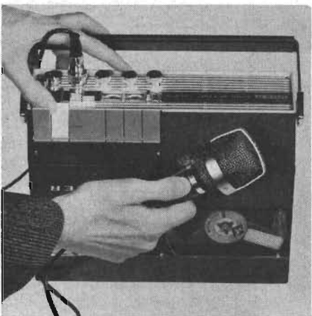
Fig 4. Uher Report är en till dimensionerna liten maskin, som framgår av fotot. Den är lätt och bekväm att manövrera genom att reglagen samlats inom »grepphåll» och är till större delen möjliga att sköta också med behandskade händer — undantag: Volym- och nivåkontrollerna. Vid »mobilt» bruk av bandspelaren gäller allmänt att man bör söka ställa upp eller lägga den snarare än att ha den i handen eller över axeln, också om det senare alternativet ger godtagbart svaj. Men alla häftiga rörelser eller onormala lägen påverkar inspelningsen ofördelaktigt.
