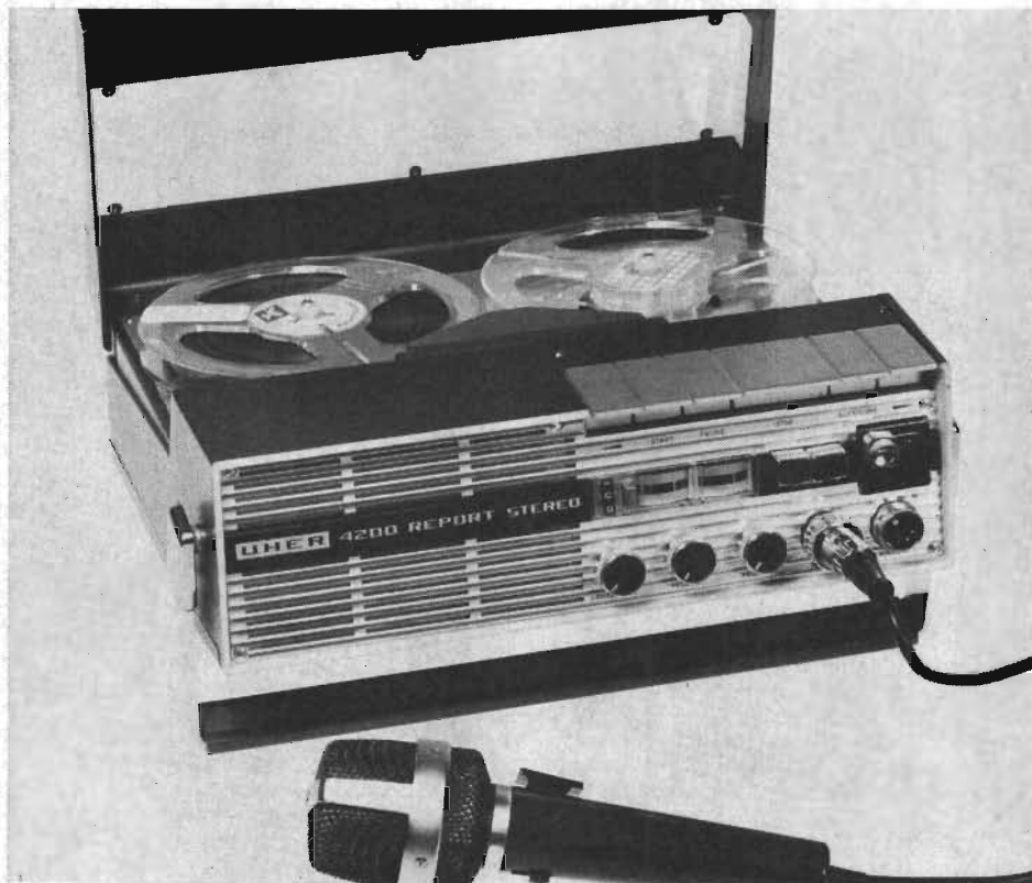
Fig 1. Uher Report i sitt senaste utförande, som två- resp fyrsparmaskin med beteckningarna 2200/4400 Stereo uppvisar till det yttre föga skiljaktiga drag jämfört med tidigare versioner. På den välbekanta, något dekorlastade fronten, har i huvudsak tillkommit ännu en utstyrningsindikator, en nivåkontroll och en mikrofoningång. Mikrofonen (standardtillbehör) är en bra sådan. Man använder bl a Beyer och Sennheiser som mikrofonleverantörer. Via miken kan start/stopp ske.
