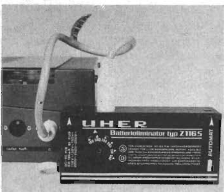
Fig 3. Vid nätdrift används batterieliminators Z 116 S, som via medlevererad DIN-kontaktförsedd kabel pluggas in i den triangelmärkta anslutningen. Det finns också en laddningsbar ackumulator i tillbehörs-serien till Uher Report.
