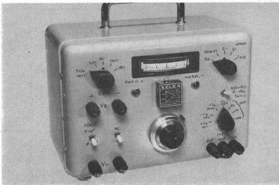
Fig 14. Instrument för produktionskontroll av operationsförstärkare.
