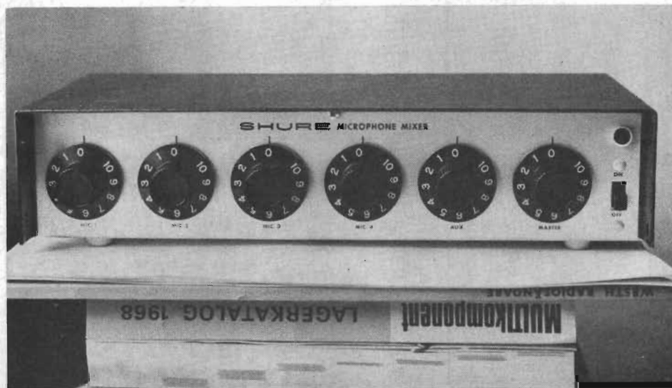
Fig 1. Mikrofonmixern M 68 från Shure, USA, är som synes behändig till formatet — jämför böckerna den står på! Den är också mycket lätt och lämpar sig väl för portabelt bruk. Huvudregeln sitter längst t h på frontpanelen. Till/frånslaget syns bredvid, och överst indikatorlampan som lyser med rött sken vid drift.
