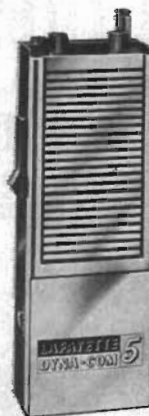
Lafayette Dyna Com 3A 3 W 3 kanaler 12 transistorer Tonanrop Pris 585:—
