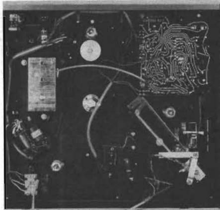
Fig 6. En blick in i chassiet med kretskortet längst upp th, motorns inkapsling tv och den fotoelektriska avstängningsanordningen nedtill åt höger. Foto RT.
