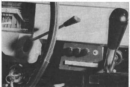
Fig 4. Manöverpanelen med tryckknappsväljarna för resp fartområdes förinställning.
