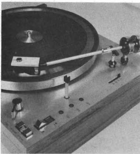
Fig 2. Tonarmsutformningen och verkplattans manöverorgan. Märk tonarmshuvudet med skruven för den utbytbara pickupen. Den förskjutbara motvikten på armen syns intill tonarmsliften. Foto RT.
