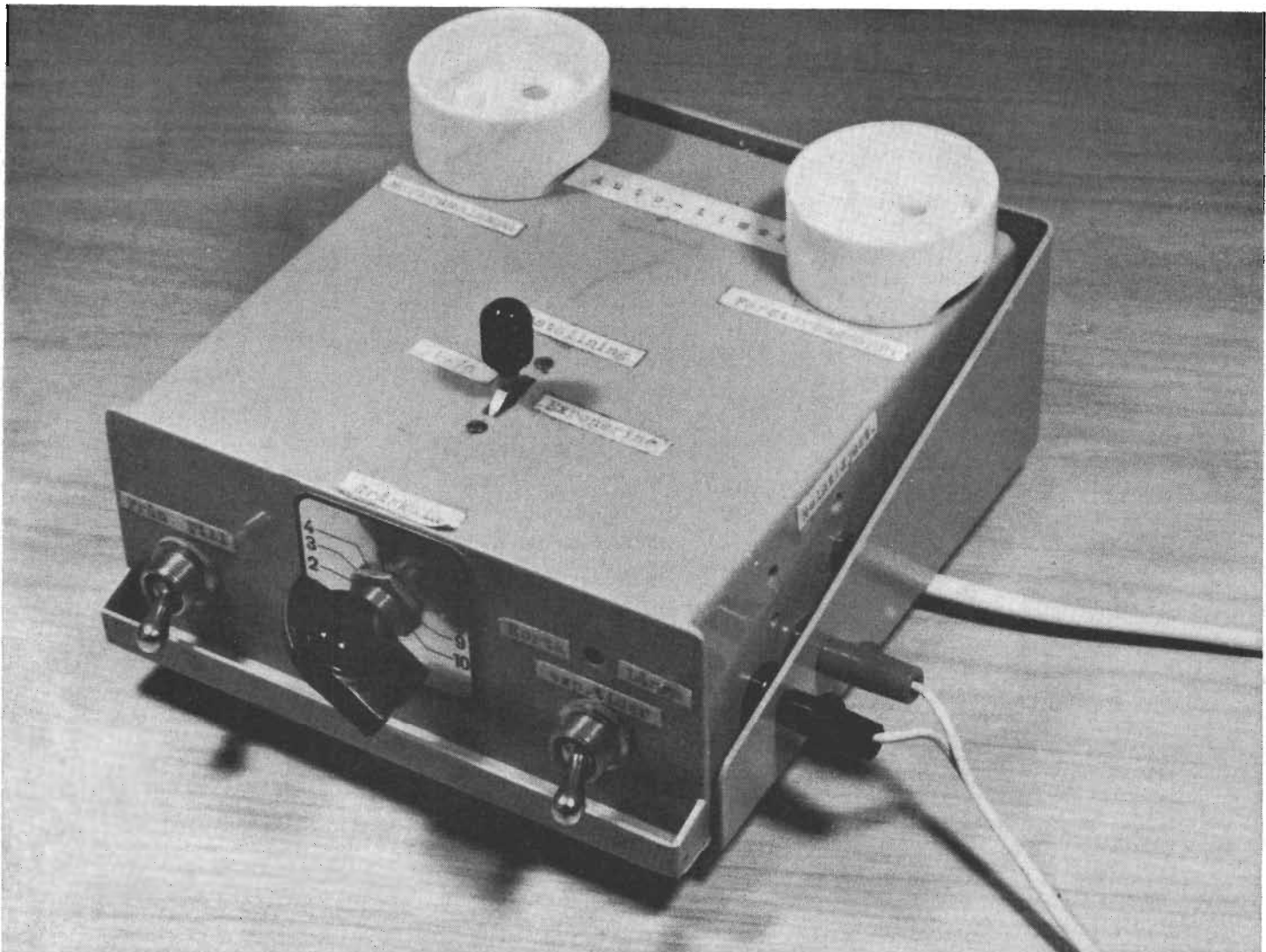
Fig 2. Den färdiga kalkylatorn med vippomkastare O 1 på ovansidan tillsammans med uttag för förstöringsapparat och mörkrumslampa. Pilratten i mitten är till för inställning av önskad gråskala och till höger om den sitter omkopplaren för papperskänsligheten.
