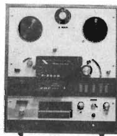
Senaste stora Akai-bandspelaren: X 360 D. Speciell finess: En lampa indikerar ev smuts på tonhuvudena!
