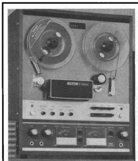
Teac-modellen A 6010 ses tv och som framgår av bilden skall den köras stående i likhet med övriga modeller av detta märke. Märk bandföringen!
