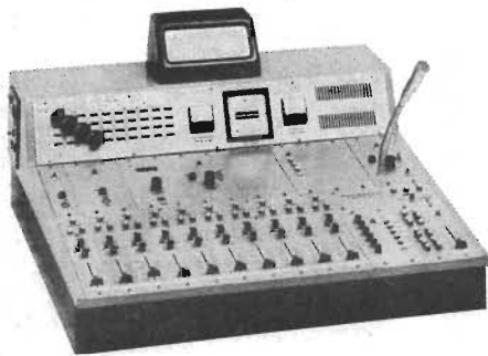
Några exempel på enheterna från tyska Difona-Elektronik . Enheterna är uppbyggda på kisel planer-teknik. Kassetterna är normerade till dimensionerna 220 \times 52 \times 80 mm. Klirrfaktorn ligger under 0,5 %. Man har strävat att motsvara
