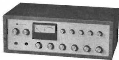
Electrodynes E-600 mixer är bl a bestyckad med integrerade kretsar.
