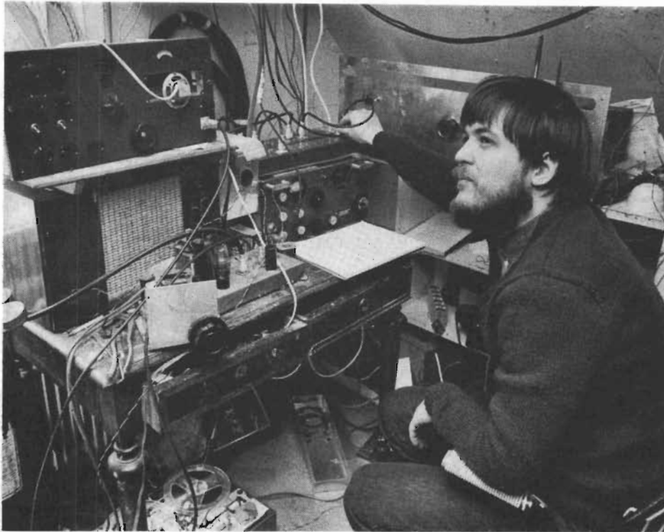
Fig 1. Leif Åsbrink i färd med att koppla in noise-blankern. På väggen i bakgrunden hänger de två rullar med koaxkabel, vilka utgör fördröjningsledningarna. I segrarens välförsedda QTH finns bl a även en precisions-VFO för 144 MHz med upplösningen 20 Hz samt faskänning till Motala långvägssändare, vilken har frekvensnoggrannheten 10^{-11} .
