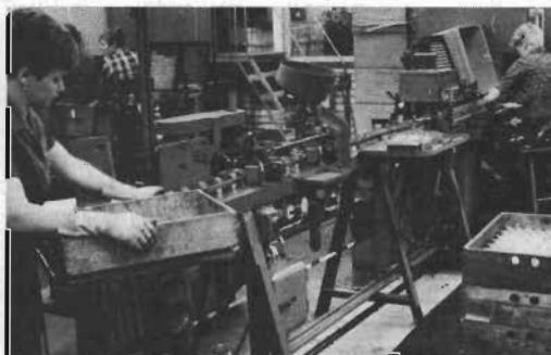
Fig 12. Monteringslinje för R20-celler. Från höger utföres bl a följande moment: vaxning, påsättning av mässingshatt, påsättning av skyddsbricka, övervikning (stukning) av zinkkanten över skyddsbrickan.
