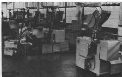
Fig 9. Zinkbägarpressar. Varje sådan maskin kan forma 90–150 st R20-bägare per minut. Överst inmatas utgångsmaterialet, 30 mm zinkrondeller (»kalotter»). Under betydligt mer än 100 tons tryck pressas rondellerna till bägare, rätt höjd på bägarna skärs till, bottenstjärna skjuts in och slutligen fasoneas (»sickas») bägarna i kanten. De tre sistnämnda momenten försiggår i maskinen närmast kameran.
