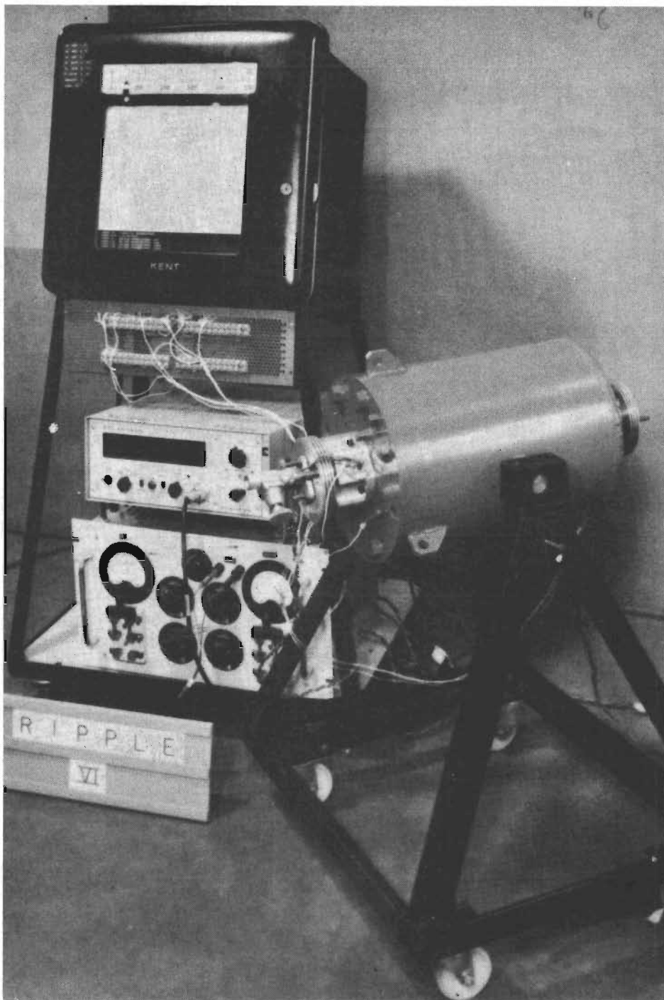
Fig 1. Rippel VI, den brittiska isotopgenerator som nu strömförsörjer ett inseglingsljus i Stockholms skärgård, under leveransprovning. — Generatorn, som lämnar 1 W, är inrymd i cylindern th på bilden.
