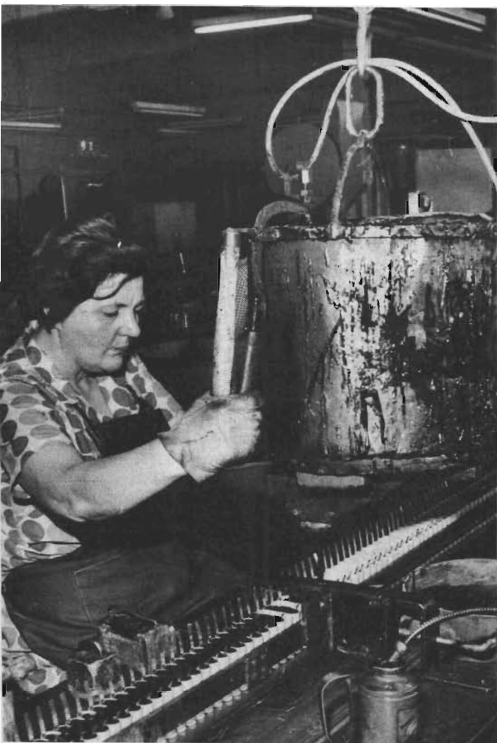
Fig 7. Ett av sluskskedena vid tillverkning av 4,5F1; asfalt gjuts över de tre R12-cellerna. Innan dess har batterierna passerat en mätanläggning där ev icke godkända automatiskt sorteras bort.
