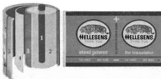
Fig 1. Transistorbatteriet, typ 736 »Steel Power» i genomskärning: 1) kolstäng, 2) plus-elektrod av brunsten och grafit, 3) elektrolyt, 4) zinkbägare, 5) isolerande cylinder av bitumenpapp, 6) stålmantel. — T h ny text-layout på stålmanteln.
