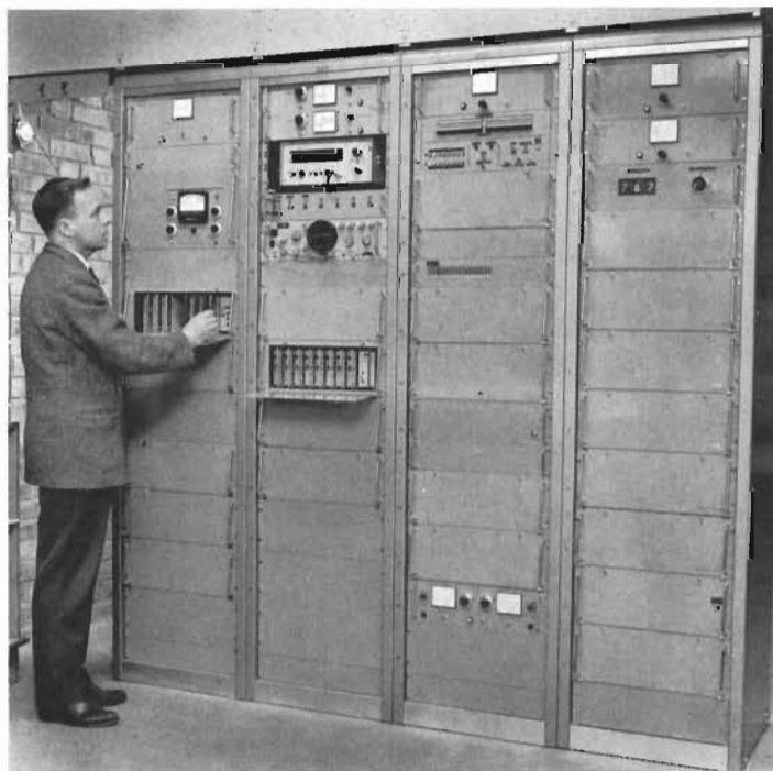
Kontrollutrustning för provning av Viggens motor RM8 levererad till Svenska Flygmotor Aktiebolag, Trollhättan
