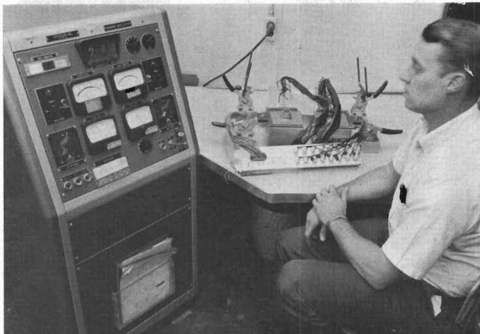
Fig 5. En automatisk kabelprovare, programmerad att utföra högspänningskontinuitetstest vid varje kabelförbindning. Om ett fel begåtts vid kopplingen, indikerar apparaten detta. Instrumentet upptäcker också potentiella isoleringsdefekter mellan högspänningskablar och kopplingsdonen.
