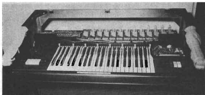
Fig 2. Orgeln under arbete. — Obs att sidorna skyddats med pappersvadd ur förpackningen för undvikande av repor och åverkan.
