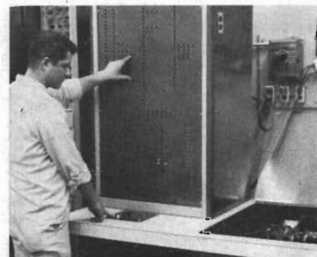
Fig 7. Kablageprovaren, också byggd av GEC, ger möjlighet till kontroll av varje anslutning. Kablaget sätts i fixturen till höger på bilden och kontrolleras med hjälp av steg för steg-omkopplaren på panelen längst ned till vänster.
