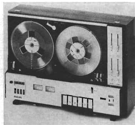
Fig 13. Ur Philips-serien bandspelare väljer RT-översikten N 4500. Maskinen har fått skjutpotentiometrar på fronten och nya reglage för betjäningen.
