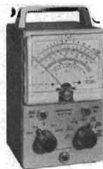
Rörvoltmeter IM-18E 1,5 V–1 500 V AC och DC. Resistans 0,1 ohm–1 000 Mohm.
