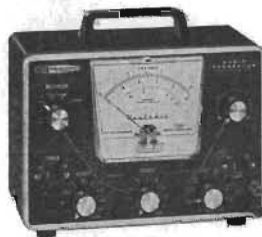
Tongenerator IG-72E 10 Hz–100 kHz, 0–10 V. Dekadisk inställning av frekvens. Försedd med visarinstrument för mätning av utspänningen kalibrerad i volt och dB.
