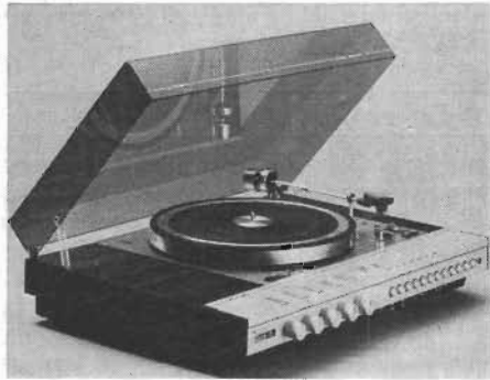
Fig 6. Radio AB Dux satsar nu stort på ett ljudprogram där förnämsta exponenten är DX 5891, en 60-wattare med 32 transistorer. Philips Electronic-skivspelare ingår samt en FM-del med snabbval av stationer.
