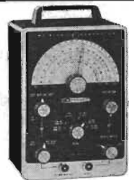
Signalgenerator IG-102E 100 kHz–220 MHz \pm 2%. Sex frekvensband. Stor noggrann kalibrerad skala. Modulerad eller omodulerad utsignal. Intern 400 Hz signal för modulation eller LF arbeten.
