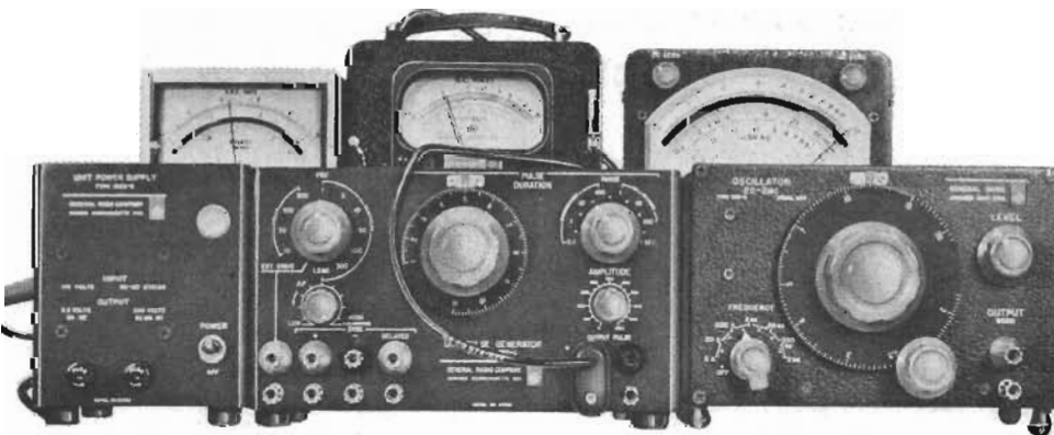
Fig 1. Alla tre instrumenten visar faktiskt rätt! Men de mäter spänningarna på olika sätt. Instrumenten är från vänster effektivvärdes-, medelvärdes- och toppvärdeskännande och deras utslag är 4,4, 2,1 resp 13,5 V. De mäter på 50 \mu s pulser med 1 kHz prf och amplituden 20 V.
