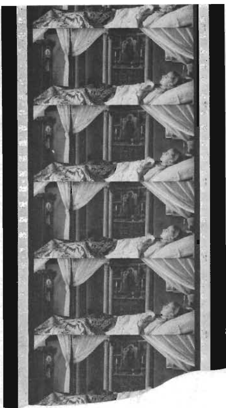
Filmstrip av en 70 mm:s Todd AO-produktion, alltså ett vidfilmsystem av senare datum. Intill perforeringen på båda sidor ligger magnetspåren med sexkanaligt ljud.
