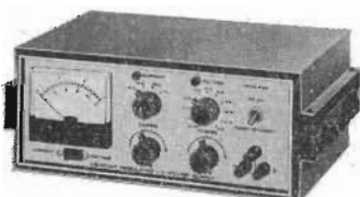
Kraftaggregat IP-27E 0,5-50 V, 1,5 A. Kortslutningssäker, inställbar strömbegränsning.
