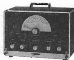
Sinus-fyrkantgenerator IG-82E 20 Hz-1 MHz, 0-10 V. Distorsion mindre än 0,25 % för sinusspänningen och stigtid mindre än 0,15 \mu s för fyrkantspänningen.
