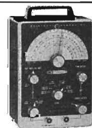
Signalgenerator IG-102E 100 kHz-220 MHz \pm 2%. Sex frekvensband. Stor noggrann kalibrerad skala. Modulerad eller omodulerad utsignal. Intern 400 Hz signal för modulation eller LF arbeten.
