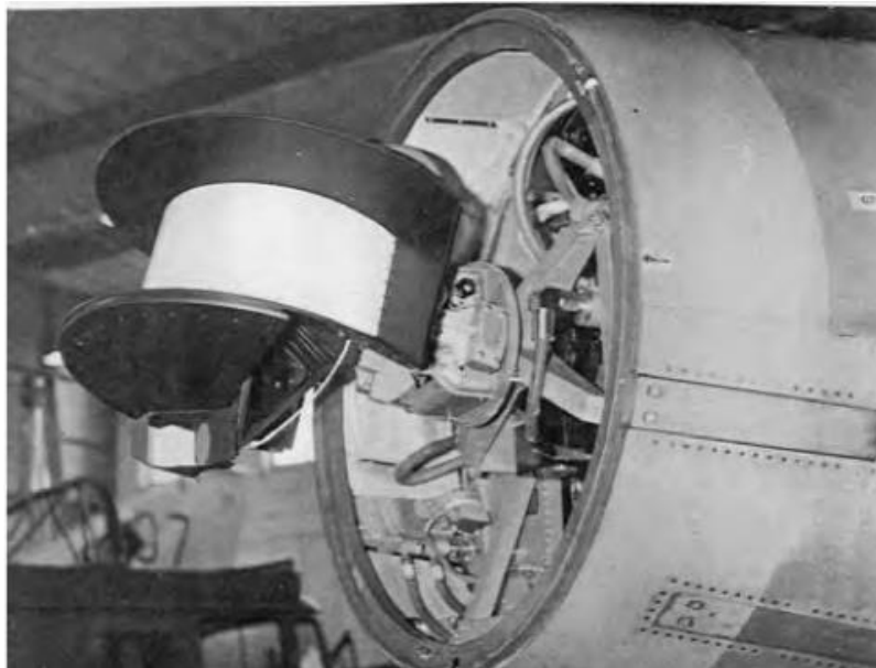
Antenner och vridbord i nosen på Fpl A32
