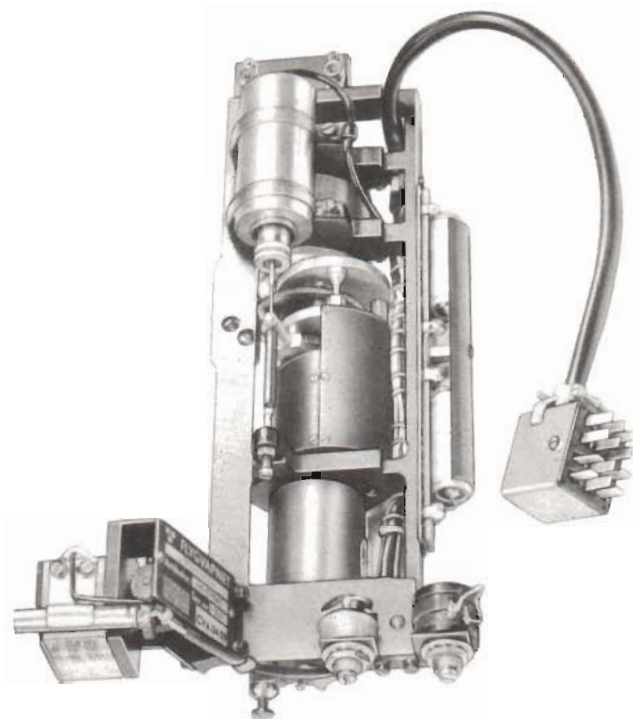
Bild 5. Strobmekanismen monterad ur fnav-indikatorn
