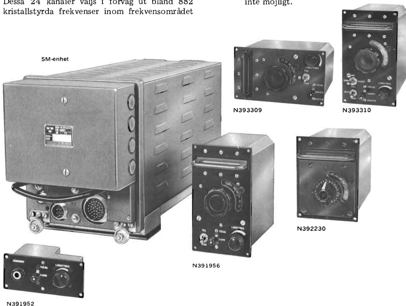
Bild 1. Flyradiostation FR 12 (4 alternativa utföranden av flygförarens manöverapparat).
