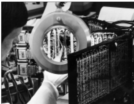
Kontroll av att lödningarna är bra sker under förstoring.
