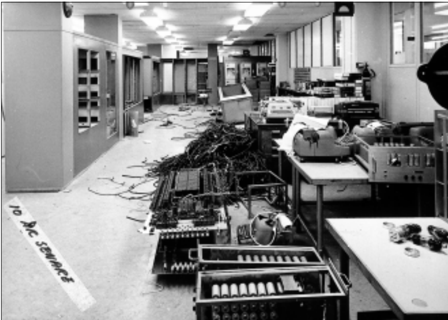
När Sara skrotades 1967 efter tio års tjänst, skingrades alla delarna utom kärnminnet (hitom sladdhögen i bilden), som förvaras i Datasabmuseet på Linköpings Tekniska Högskola.
