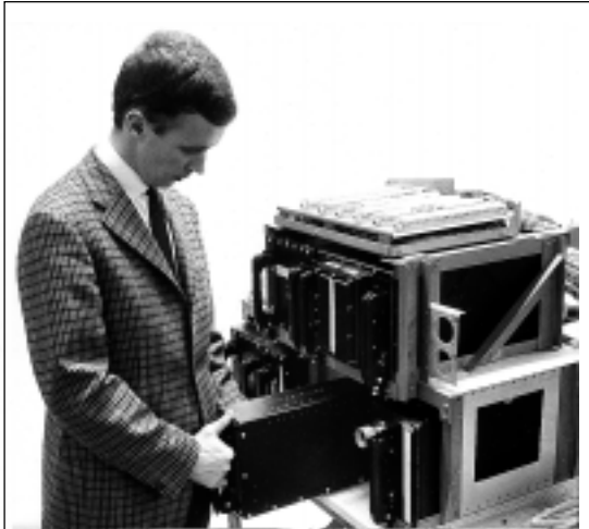
Fig. 5. Datamaskin CK37. Installation i flygplansrack.
