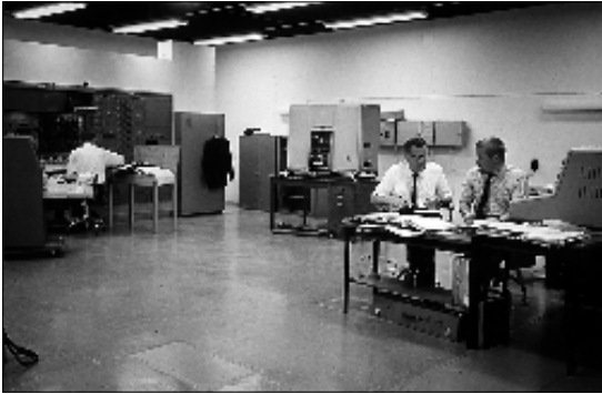
Tidig simulering av delfunktion i Viggen med hjälp av analogmaskin (till vänster), Sank/D2 (i mitten) och CK37-prototyp (till höger). Bilden är från 1964.
