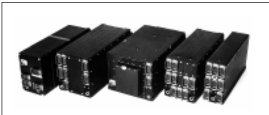
Fig. 4. De fem apparatenheterna som utgör datamaskinen CK37.
