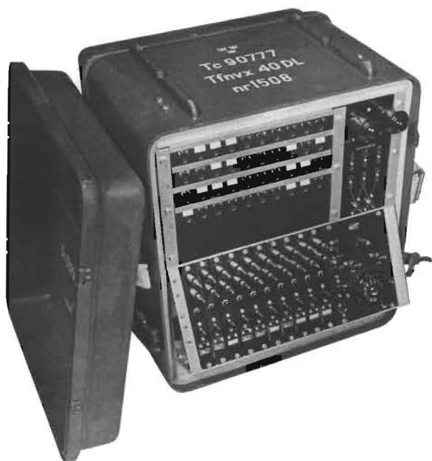
Bild 26. Telefonväxel av denna typ används i signalstationsvagnen
