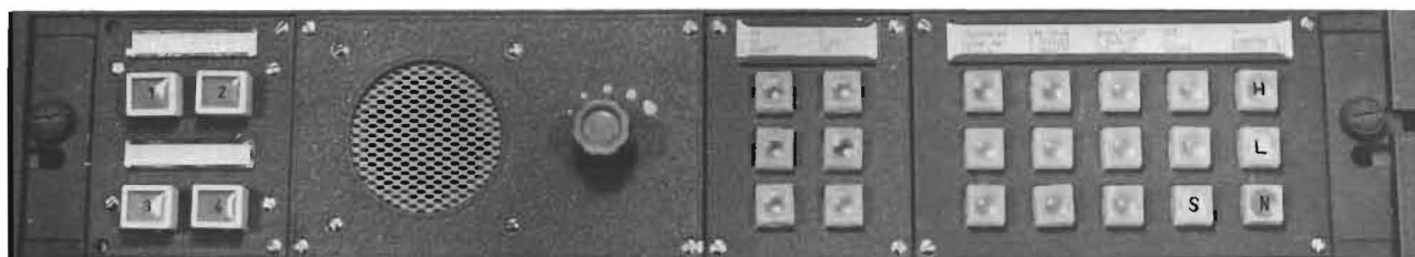
Bild 32. Längst till vänster ses manöverenheten för startorderförbindelsen. Till höger om manöverenheten sitter passningshögtalaren.
