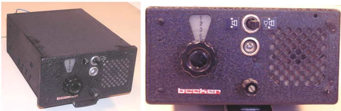
Radiomottagare AR 12, västvärldens första heltransistoriserade radiomottagare för flygplan.
