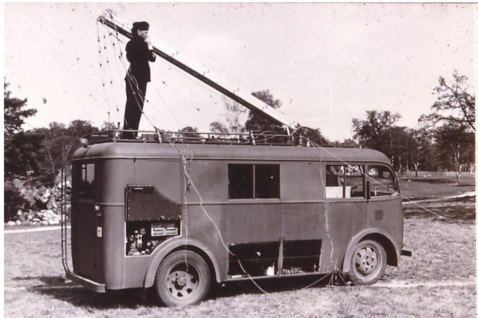
Markradiostation Tmr VIII, mast under resning. Foto Flygvapenmuseum.
