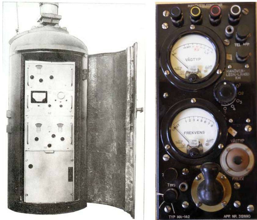
Stålkuren med avstärningsenhet KV. Manöverapparat MA-142
