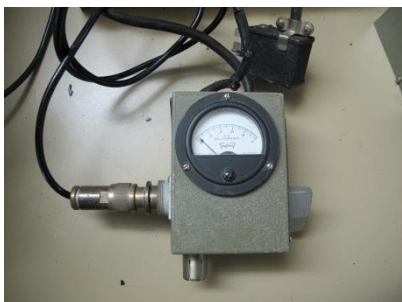
Instrument för kontroll av Antennsystemets SVF . Foto AEF
