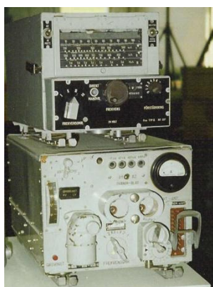
Flygradiostation Fr typ 2, mottagare överst sändare underst. Foto A Larsson
