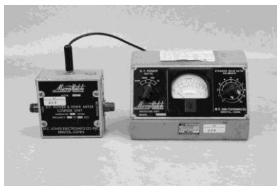
Mikromatch SVF och effektmeter. För kontroll av FR- utrustning i Flygplan 29 m.fl. Foto AEF
