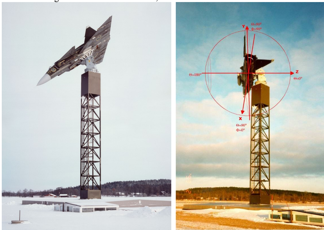
Flygplan 37 på AMPA:s mast och treaxliga vridbord JA37 lutat 90 grader
